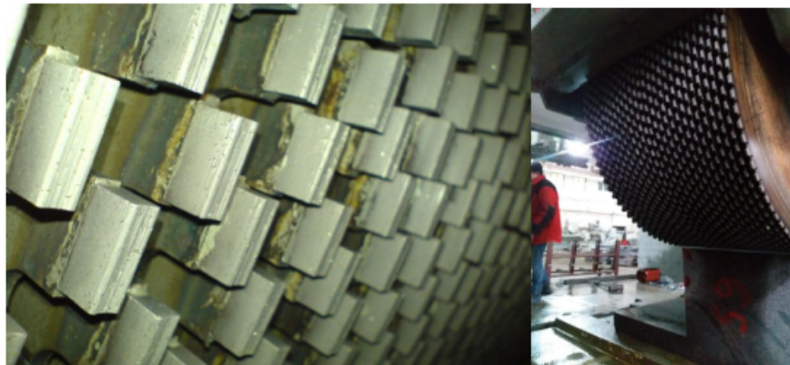
图 3 用于切割花岗岩装饰板的直径为 1200 毫米圆盘磨片
