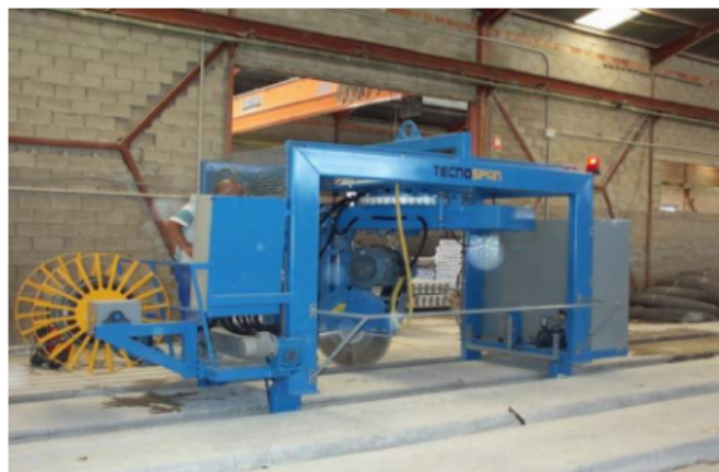
图4 用于在空心板生产线上切割预应力钢筋混凝土的900mm圆盘磨片
