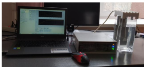
图1 - 微弧氧化的软硬件复合体
