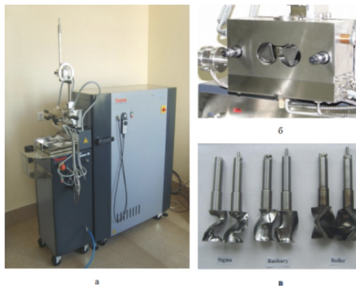
a - 整体外观; b——带转子的混合室; c - 一组转子
